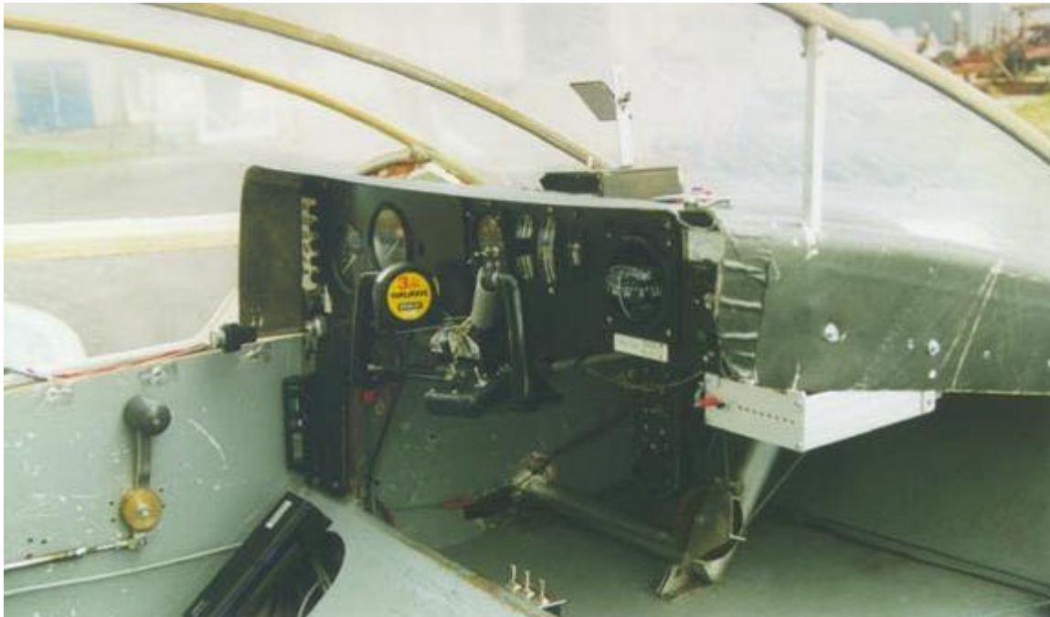
Cockpit mit Schaltung für das Getriebe der Hauptantriebsanlage sowie zusätzlichen Bedienelementen für das Direct-Height-Control-System
