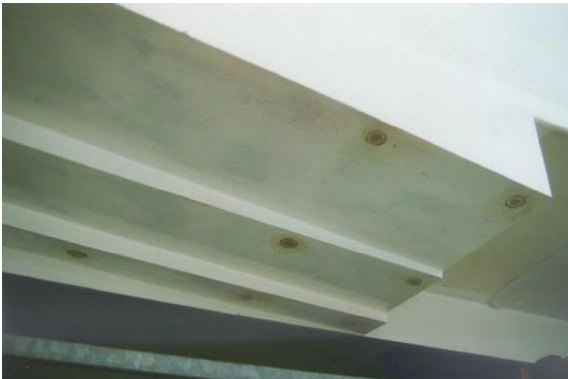
Längsstufenbug mit Anordnung der Drucksonden zur Messung der Belastungen beim Start Foto 4
