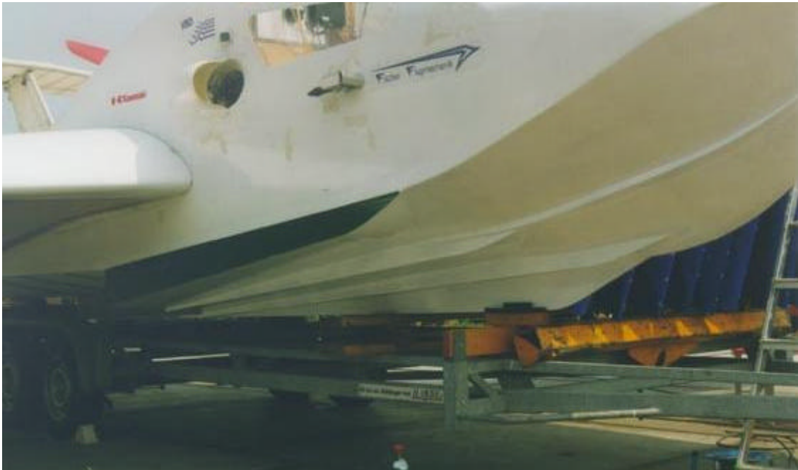
Längsstufenbug mit Abdichtplatte als nachgerüstete Modifikation 1999 Foto 3
