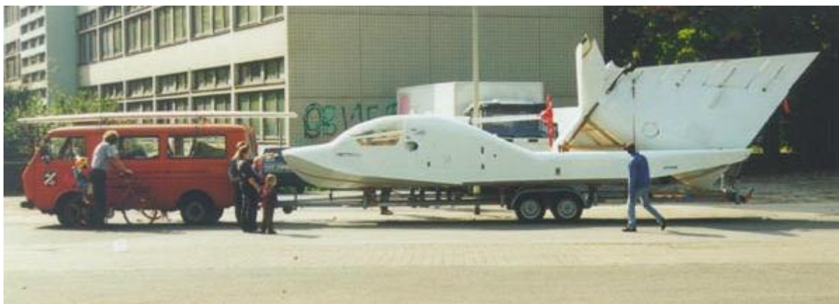
Transport des Hoverwing, Höhenleitwerk auf den Zugfahrzeug, Hauptflügel zwischen Katamaranschwimmern und Pylon
