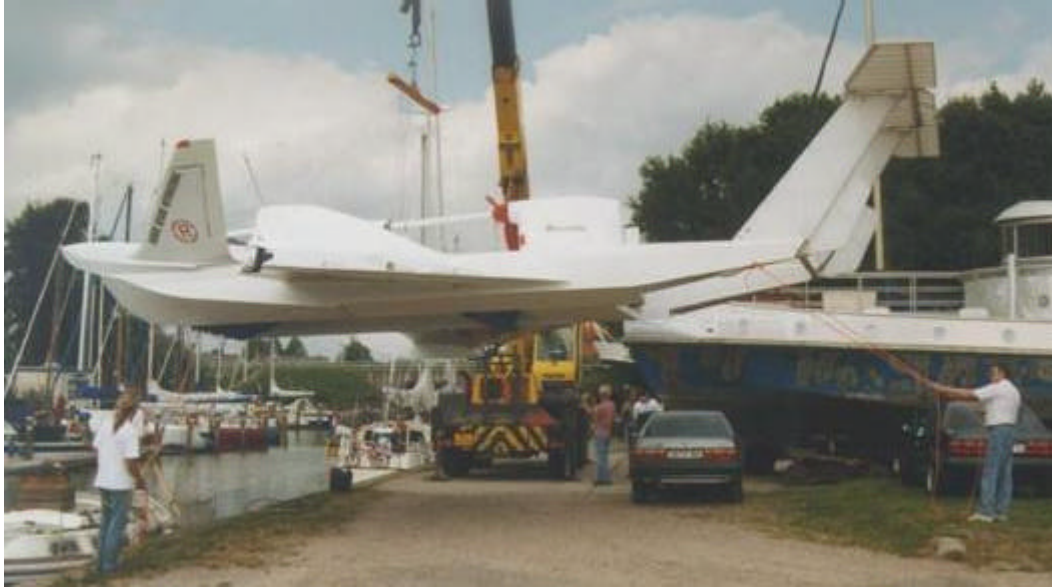
Zuwaterlassen des Versuchsträgers mit dem Kran, elektrische Manövrierantriebe an den Außenschwimmern
