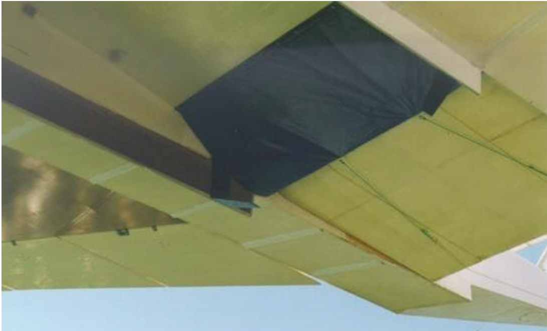
Hydrofoils im Hinterschiff montiert, Heckschürze durch Gummiseile nach hinten gespannt
