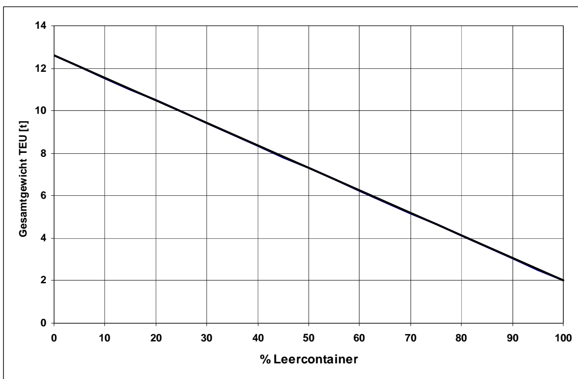
Abb. 1: Gesamtgewicht eines TEU in Abhängigkeit des prozentualen Anteils der Leercontainer
