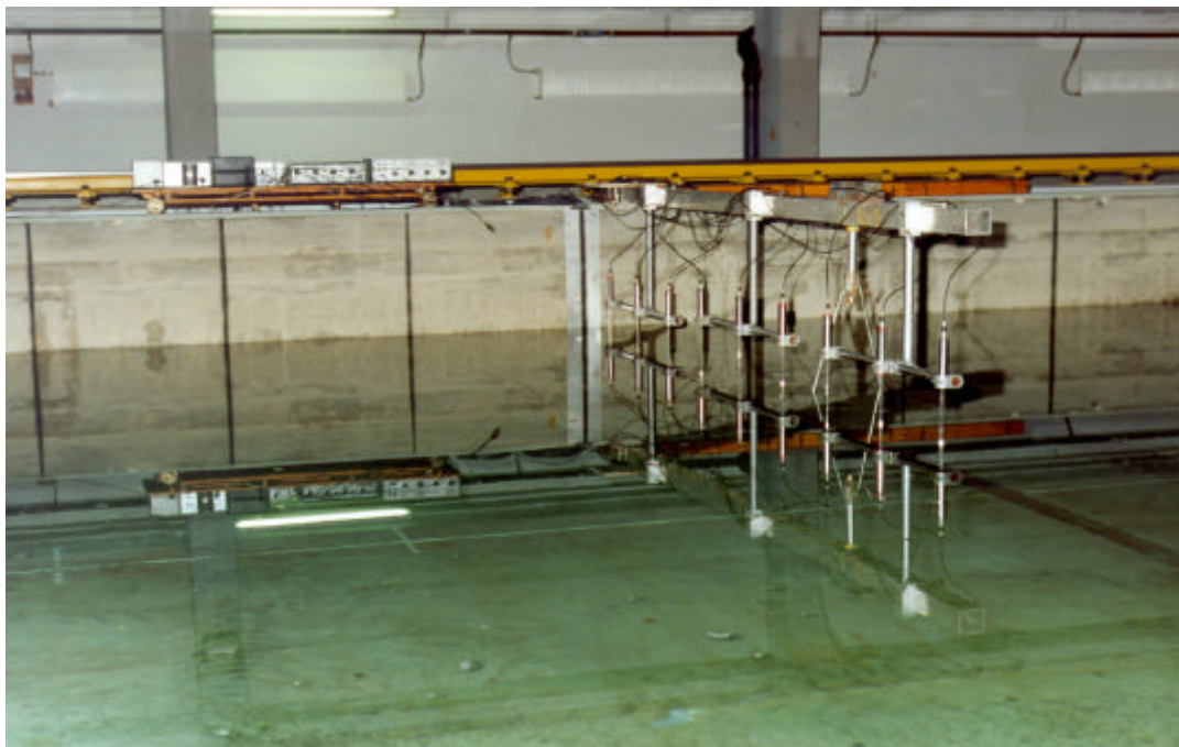
Ortsfeste Anordnung der Wellensonden im Meßquerschnitt des Schlepptanks
