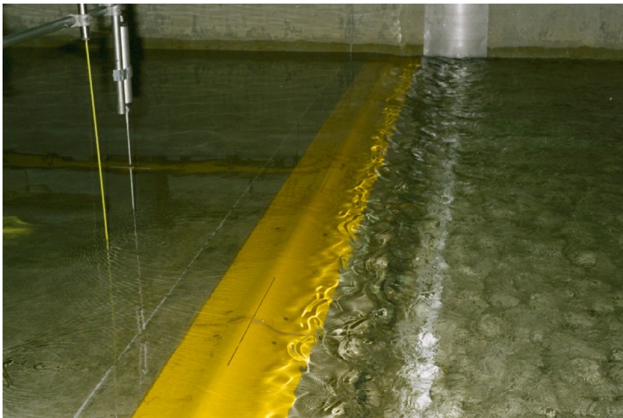
Abb. 3.3 Wellenbild hinter der angeströmten Buhne
