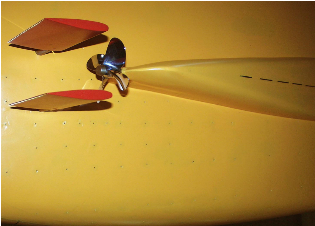
Abbildung 5.1: Anordnung der Druckbohrungen
