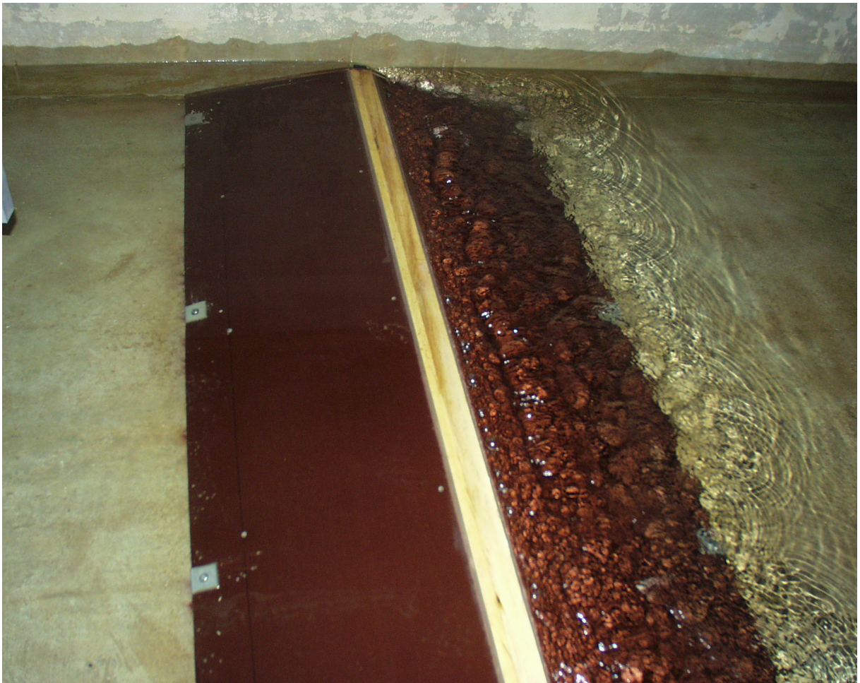
Abb. 3.4 Schießende Strömung über eine getauchte Buhne
