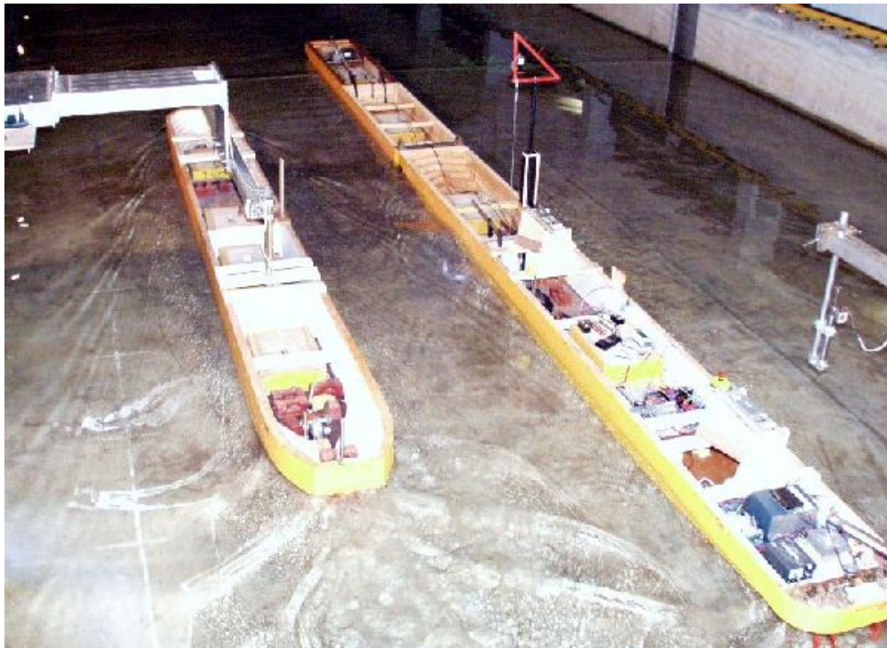
Abb. 3 Frei gefahrenes Manöver: Ein Gütermotorschiff überholt einen Schubverband
