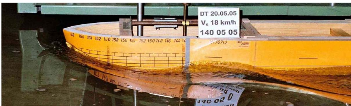
Abb. 12: Bugwelle,  $P_D = 845$  kW,  $V = 18$  km/h, scharfer Übergang
