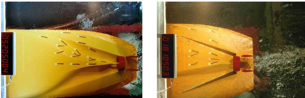
Abb. 21: Getunneltes Hinterschiff Version D (links) und 1. Hinterschiffsvariation, Schürze in Position A Version E
