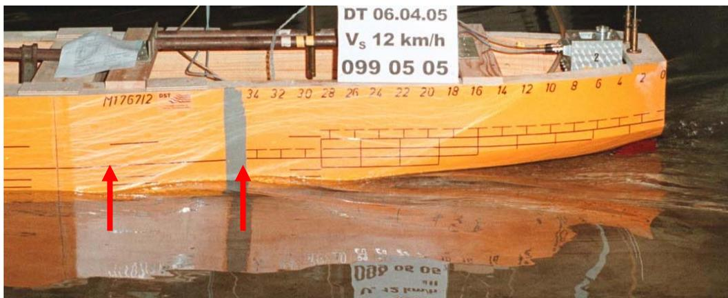
Abb. 9: Übergang der Schiffsverbreiterung auf das alte Hinterschiff
