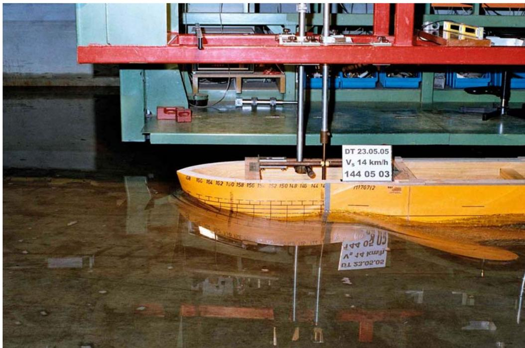
Abb. 7: Propulsionsversuche mit einem verbreiterten Motorschiff (Länge 86 m, Breite 11,40 m)
