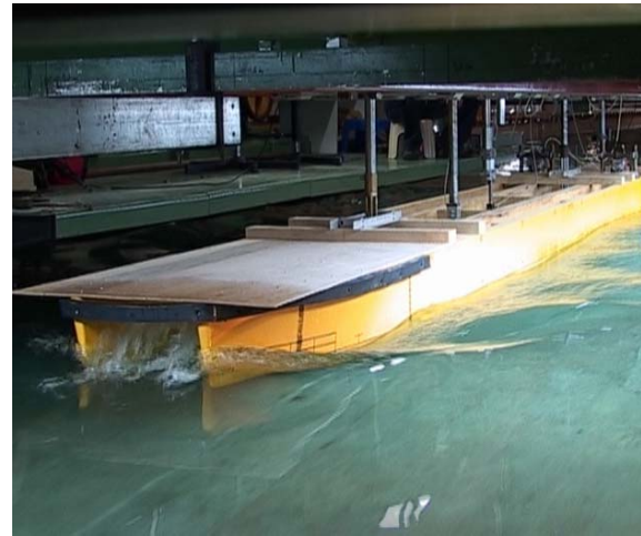
Abb. 69 Seeschlag am Vorschiff ( L = 0,5L_{WL} , H = 0,5 m)
