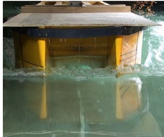
Abb. 70 Lufteinbruch unter den Mittelrumpf
