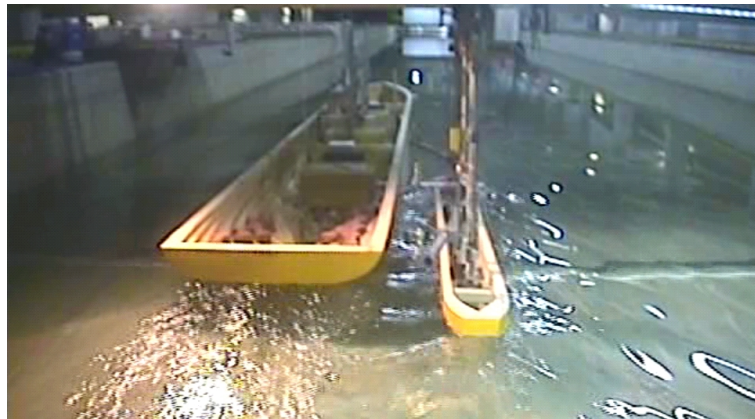
Abb. 4: Extremfall: Jumbo-Containerschiffsmodell (2093 kg) überholt Binnenschiffsmodell (48 kg)
