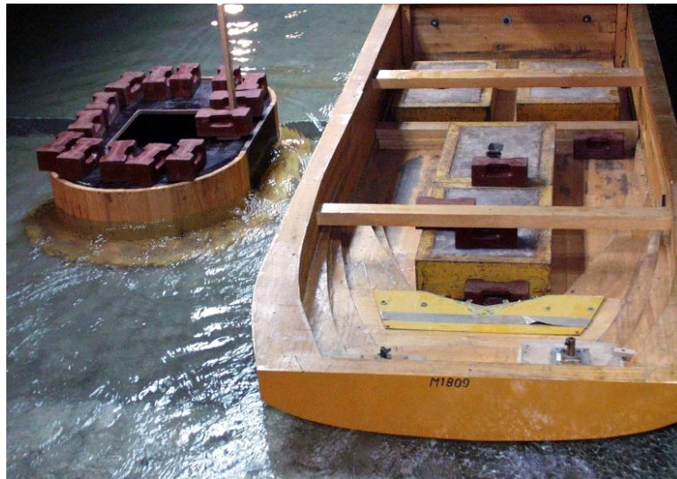
Abb. 2: Binnen-Großcontainerschiff beim Passieren eines Brückenpfeilers in Strömung
