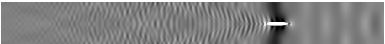
Abb. 4: Wellenbild des Kryo Containerschiffs bei h/T = 1,5 und V = 15 kn
