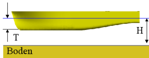
Abb. 31: Fahrtzustand mit Trimm und Absenkung aus Ruhewasserlage
