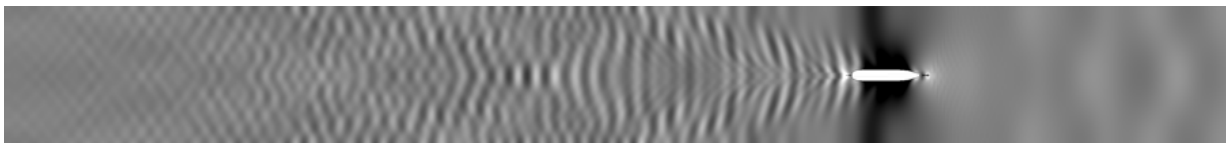
Abb. 3: Wellenbild des Kryo Containerschiffs bei h/T = 1,4 und V = 15 kn
