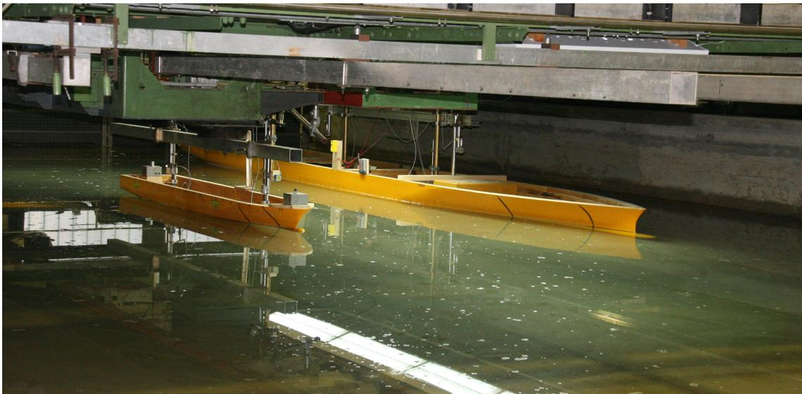
Abb. 3.3.: Versuchsaufbau mit dem Post-Panmax Schiff an der Schnellschleppanlage, das das kleine Feeder Schiff, welches am großen Schleppwagen installiert ist, überholt.
