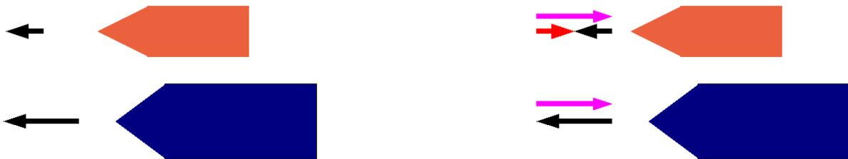
Abb. 8.25.: Überlagerung der Schiffsgeschwindigkeiten mit der Anströmgeschwindigkeit des KCS von 1,464 m/s. Der rote Pfeil zeigt die Bewegungsrichtung des Feeders in der Simulation.
