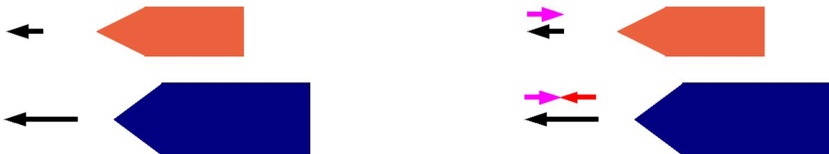
Abb. 8.19.: Überlagerung der Schiffsgeschwindigkeiten mit der Anströmgeschwindigkeit des Feeders beim parallelen Passieren.
