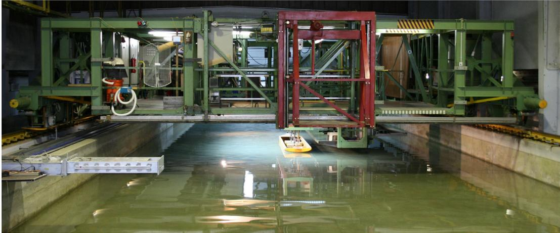
Abb. 3.2.: Die beiden Schleppwagen des DST. Links im Bild hinter dem konventionellen Schleppwagen steht die Schnellschleppanlage mit einem flachen, kurzen Ausleger, der das Passieren unter dem großen Schleppwagen erlaubt und in den hier dokumentierten Versuchen genutzt wurde.
