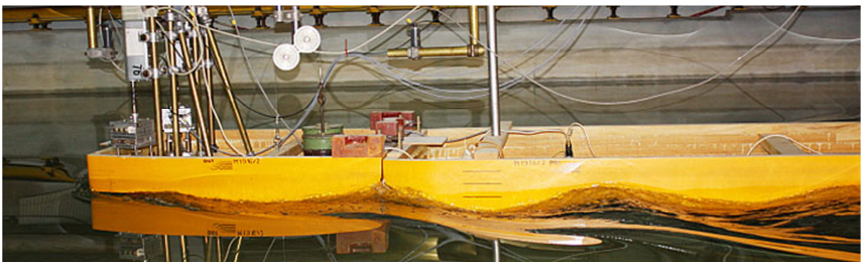
Abbildung 4: RUHRCARGO-Schubverband im Modellversuch
