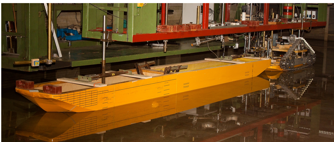
Abb. 6.5: Schubverband mit einem Leichter beim Propulsionsversuch ( h=1\text{ m} , T_{\text{Leichter}}=0,8\text{ m} )
