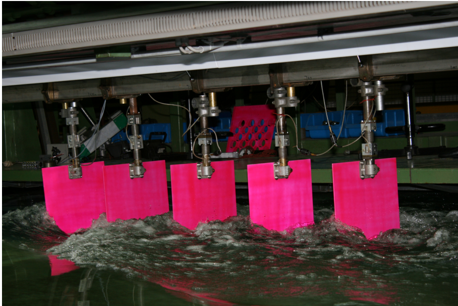
Abb. 4.7: 5 Blätter (Abstand 500 mm, Eintauchung 100 mm, Anstellwinkel 10^\circ ); (Fahrtrichtung von rechts nach links)
