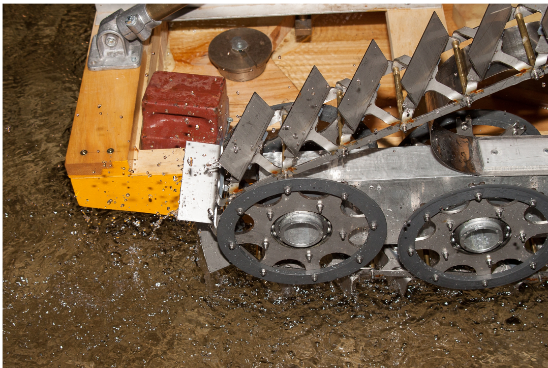
Abb. 6.7: Die geringe Spritzerentwicklung beim Betrieb der Blattkette deutet auf geringe hydrodynamische Verluste hin.
