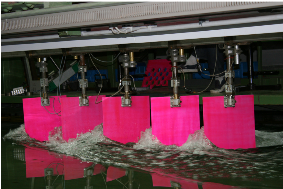
Abb. 4.8: 5 Blätter (Abstand 500 mm, Eintauchung 50 mm, Anstellwinkel 30^\circ ); (Fahrtrichtung von rechts nach links)
