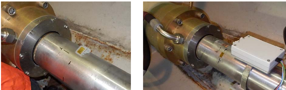
Abbildung 50: Propellerwelle mit den ersten DMS (links) und dem Messverstärker (rechts)
