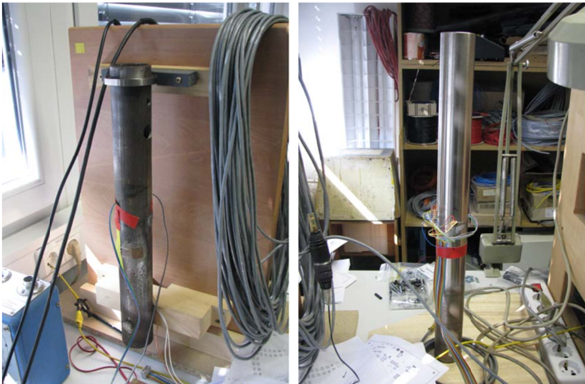
Abbildung 46: DMS an einem Rohr (links) und einem Rundstahl (rechts)
