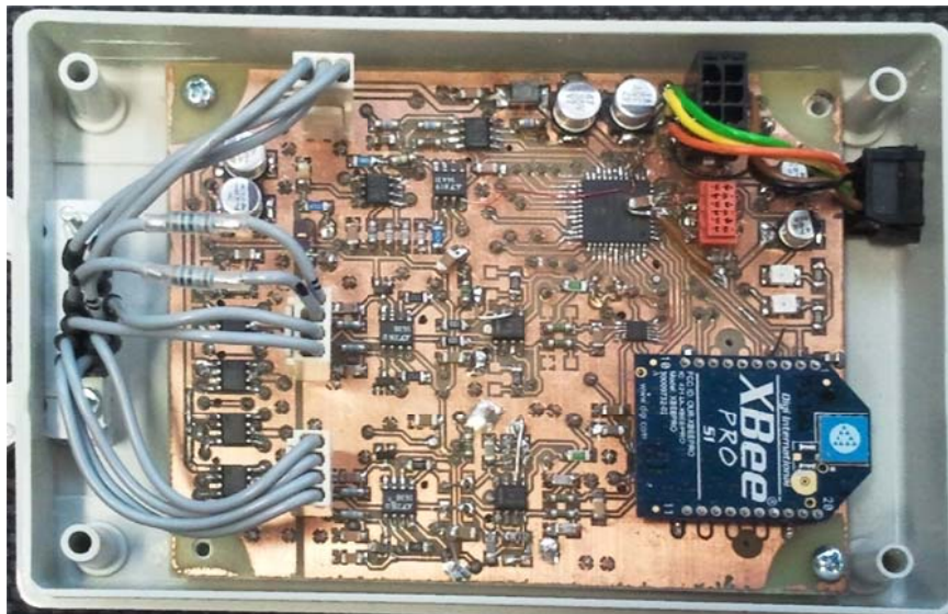
Abbildung 48: Messverstärker mit XBee Modul rechts unten
