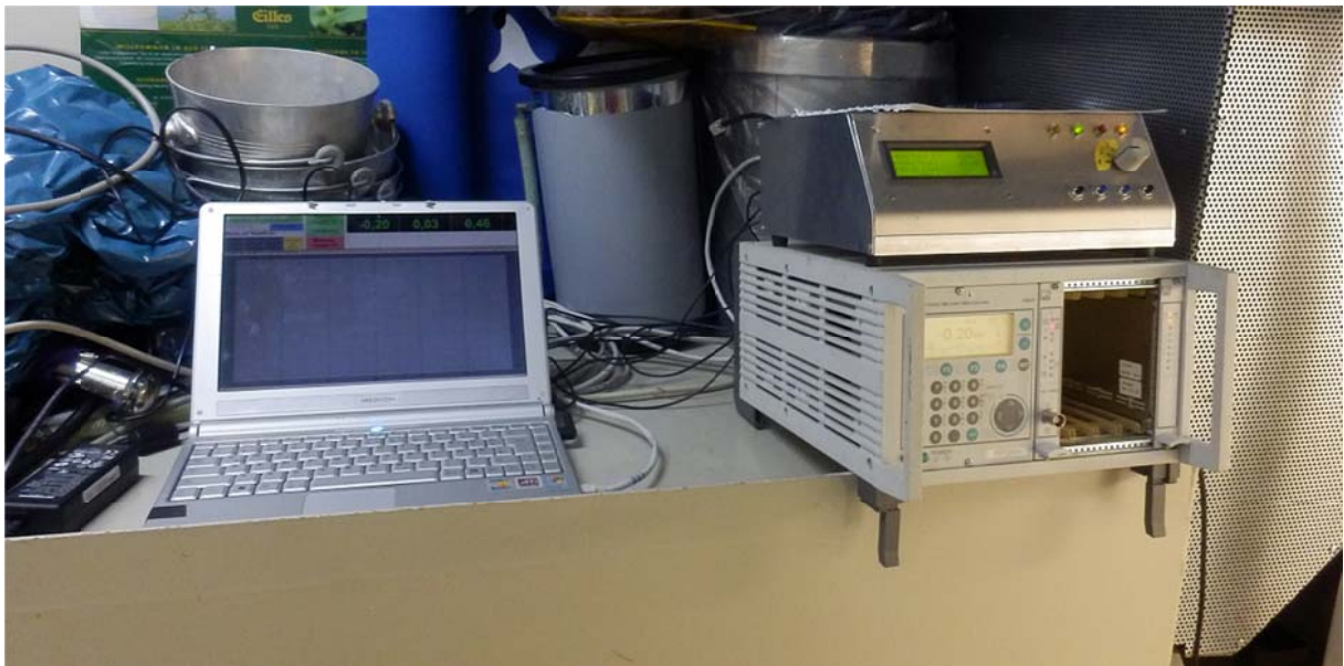
Abbildung 53: Mess-Station mit Empfänger (rechts oben), Datenerfassung und Aufzeichnung auf Laptop
