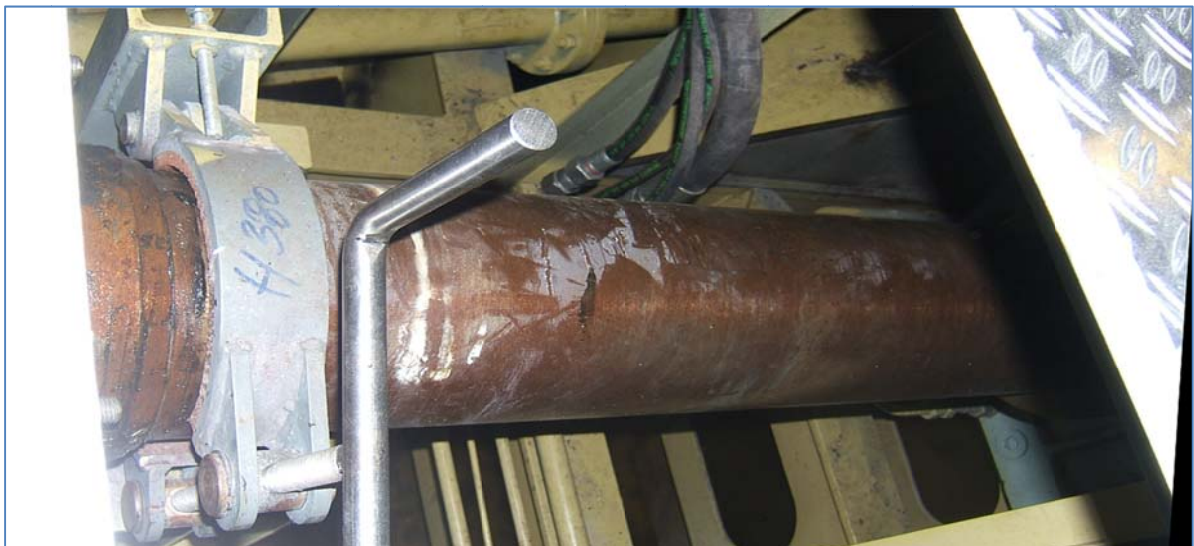
Abbildung 10: Propellerwelle mit Wellenbremse (links) und Drucklager (rechts)
