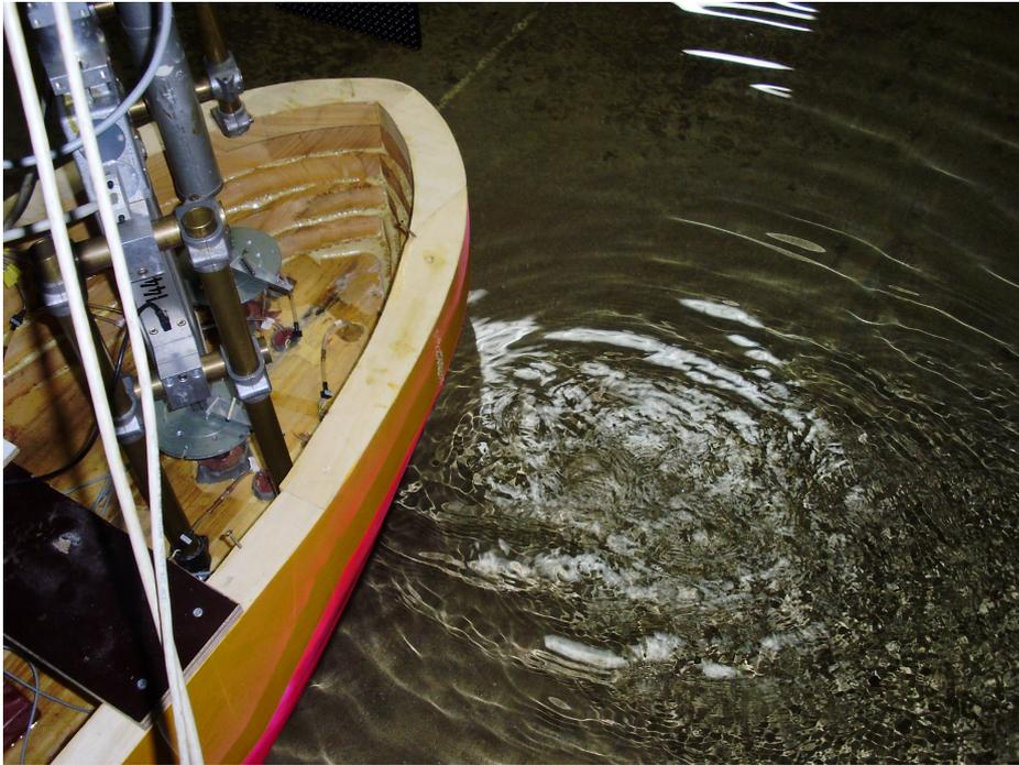
Abb. 2.19: Pfahlzugversuch mit aktivem Backbord-Bugstrahlruder nach Steuerbord gerichtet.
