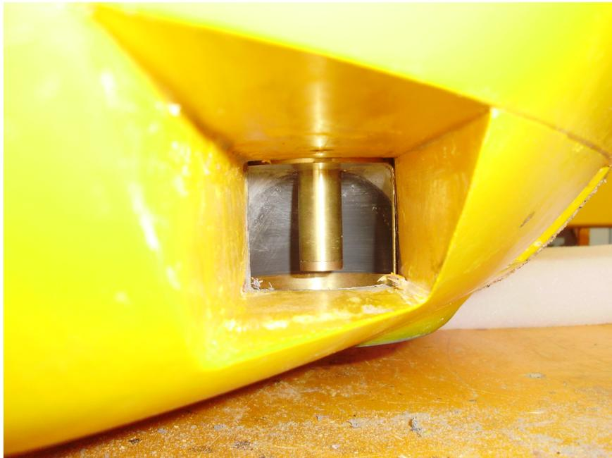
Abb. 2.6: Einblick in einen Bugstrahlruderkanal, ausgerichtet nach Steuerbord.
