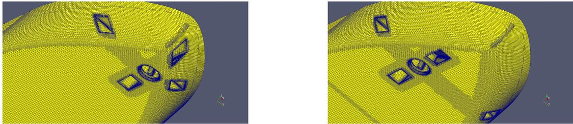
Abb. 5.15: Geometrie des Backbord- (links) und des Steuerbord- Bugstrahlruders (rechts) mit jeweiligem Oberflächengitter.
