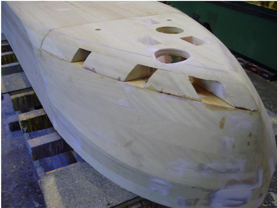
Abb. 2.3: Dieses Foto zeigt den Bug des Modells während des Baus. Die modulare Bauweise erlaubt die Integration von Sensoren und das Öffnen und Verschließen der einzelnen Kanäle.
