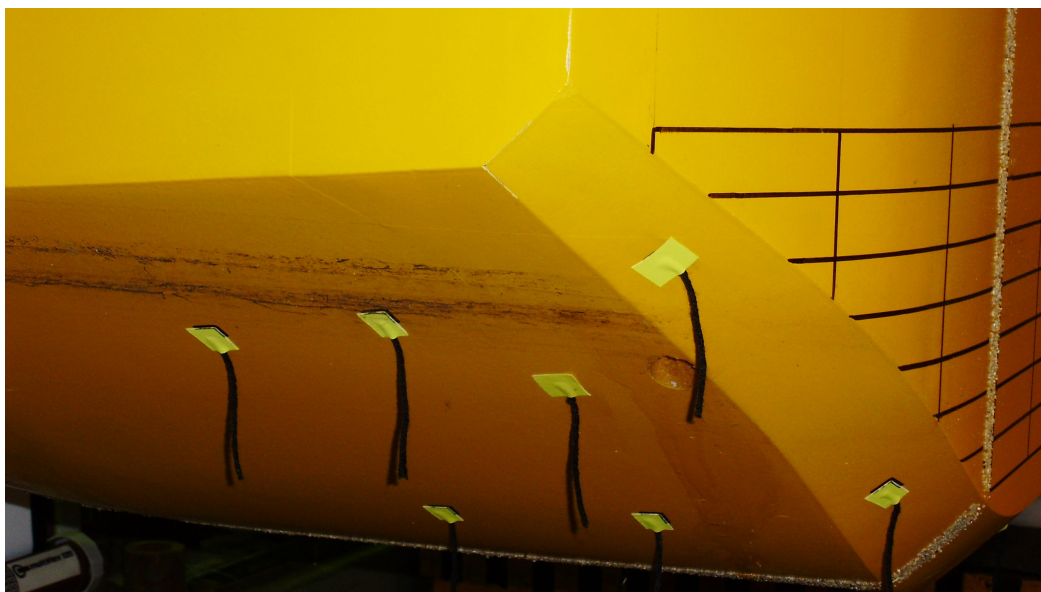
Abb. 5.1: Wollfäden und Fotonetz am größeren Modell.
