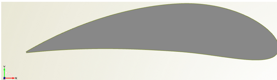
Abb. 2.35: Naca 4 digits Profil als Basisprofil für das SKATE-Profil.
