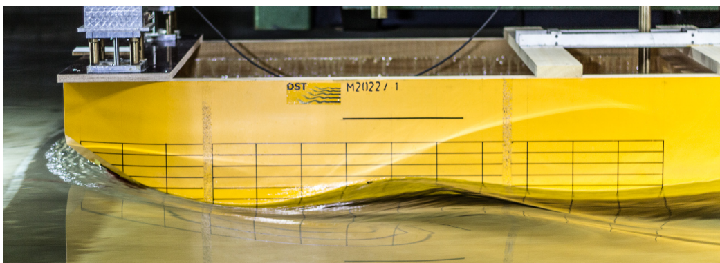
Abb. 5.2: Exemplarisches Seitenfoto der Wellenbildung am Vorschiff bei 12 km/h.
