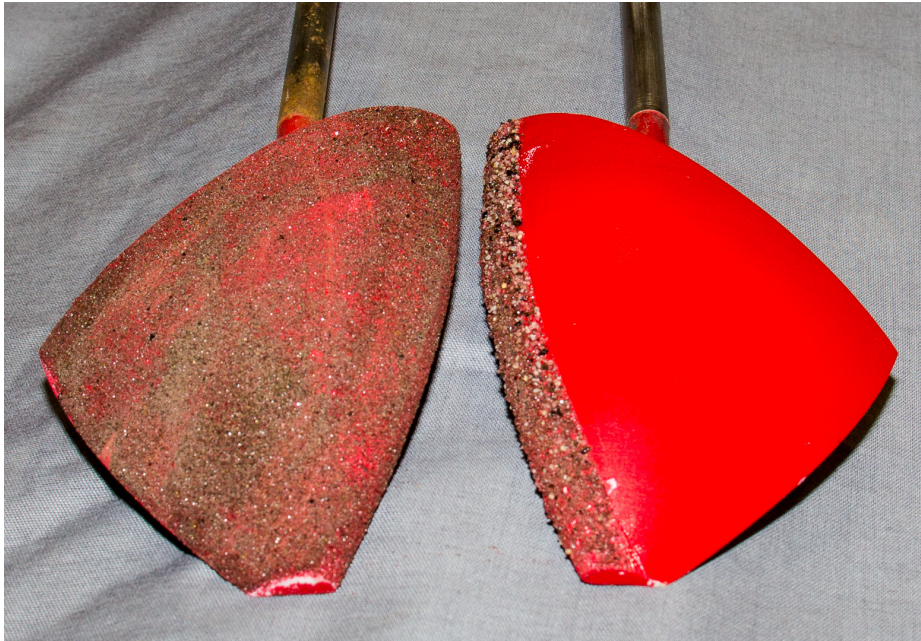
Abb. 5.11: Saugseiten der beiden SKATE-Profile mit verschiedenen Turbulenzerzeugern.
