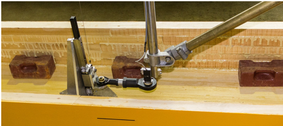
Abb. 5.3: Anordnung der Präzisionswägezelle als Widerstands-Dynamometer.
