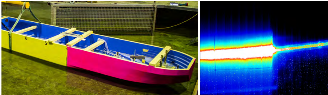
Abb. 1.4: Mit einem pinken Fluoreszenzlack können die Reflexionen des Laserlichts an der Modelloberfläche stark reduziert werden. Das Licht mit der Fluoreszenzwellenlänge kann optisch herausgefiltert werden.
